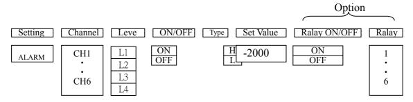
說明: 欲設定 CH1 之 Level l 高於 100℃時動作, 且欲使 Relay1 動作, 其設定如下: ALARM→CH1→L1→ON→H→100→1
